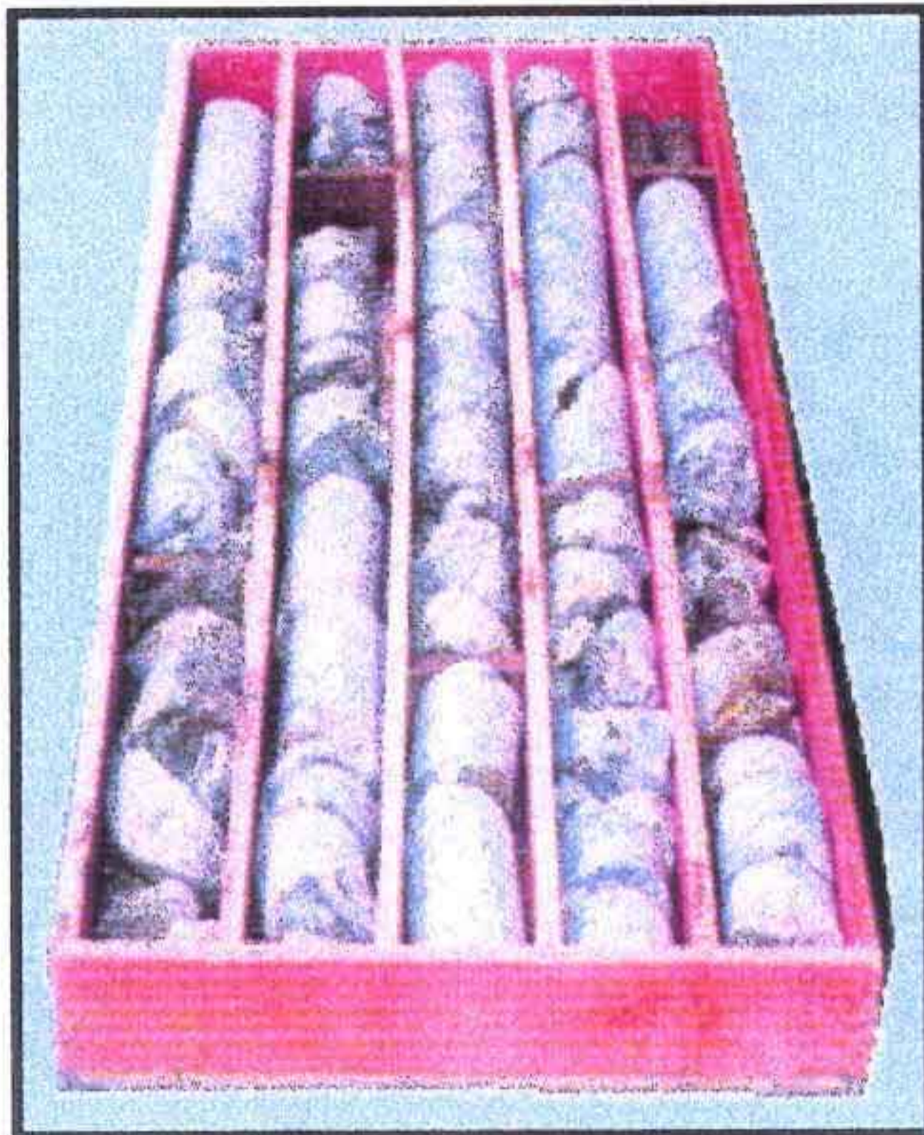
BARRAGEM MALCOZINHADO SOND. N.º SM-04 ESTACAS: 20 LOCAL: 25,00M À MONTANTE PROF.: 9,50
